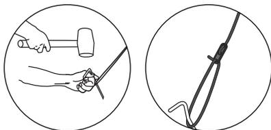
**Les haubans de la tente doivent être complètement fixés pour éviter que de l'eau de pluie ne s'accumule sur le toit ou sur le double-toit, ce qui pourrait endommager le cadre.**
