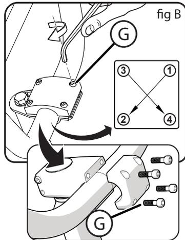
**AVERTISSEMENT** : Ne pas trop serrer le boulon de la potence. Si le boulon de la potence est trop serré, cela peut endommager le système de direction et provoquer une perte de contrôle.
