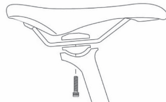
Tige de selle avec collet de serrage à microajustement intégré
