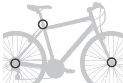
Les attaches à déclenche rapide servent le plus souvent à fixer les roues au cadre et la fourche ainsi qu'à fixer la tige de selle en position. Elles permettent des manipulations sans outil plus rapides que les connexions à écrou et boulons mais requièrent une bonne compréhension de leur fonctionnement afin d'assurer une bonne utilisation.
