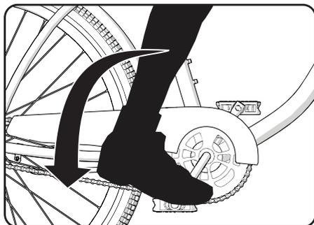
Si la bicyclette dispose de freins à étrier en plus du frein à rétropédalage, utiliser toujours le frein à rétropédalage comme frein principal pour arrêter la bicyclette.
