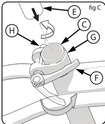
**⚠ ATTENTION :** N'utiliser la vis à papillon (F) que manuellement. Ne pas utiliser de marteau ou autre outil pour serrer la vis à papillon.
