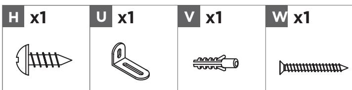
Insérez une vis **H** à travers le dispositif anti-basculement **U** dans le panneau supérieur **1**.
