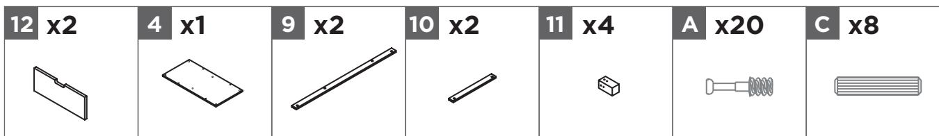
Insérez vingt boulons à cames **A** dans le panneau inférieur **4**, les pieds **11** et les devants de tiroir **12**.
