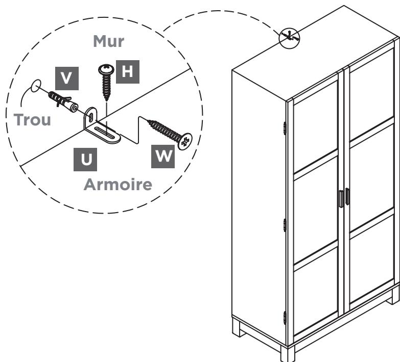
Percez un trou de 3/16 po (5 mm) de diamètre dans le mur. Enfoncez la cheville d'ancrage (v) dans le trou jusqu'à ce qu'il soit au ras du mur.
