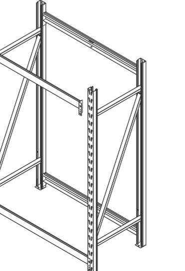
Commencez par installer la traverse supérieure arrière. Insérez les attaches de la traverse dans les deux fentes supérieures de chaque montant. Enfoncez les attaches de la traverse jusqu'au fond de la fente à l'aide d'un maillet en caoutchouc, en frappant la traverse près du joint (fig. 20). Répétez cette étape pour la traverse supérieure avant.
