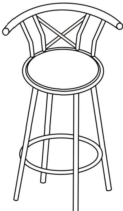
Mettez la chaise sur une surface plane, ajustez la chaise à niveau. Serrez les vis du dossier et du siège, puis serrez les antérieurs à 90% avant de les ajuster haut en bas jusqu'à la chaise est ferme. Enfin les serrez à 100%.
