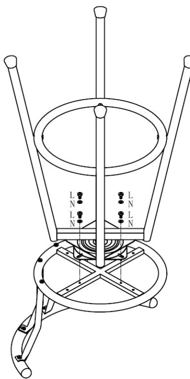
Fixez le siège au plateau tournant à 100% avec des vis.
