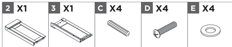
Fixez le cadre latéral gauche (2) et le cadre latéral droit (3) au bas (11) à l'aide de quatre goujons de bois (C), quatre rondelles (E) et quatre boulons (D).
