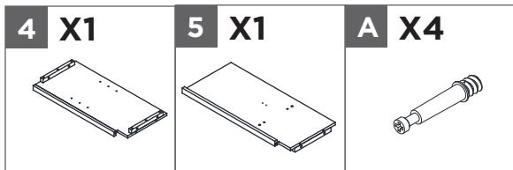
Vissez solidement quatre boulons à came (A) dans les trous désignés du séparateur gauche (4) et du séparateur droit (5).
