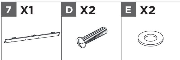
Fixez la garniture supérieure (7) en place au moyen de deux rondelles (E) et de deux boulons (D).
