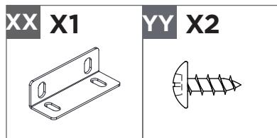
Mettez le foyer en place. Fixez le foyer à l'aide du support (XX) et fixez le support au foyer au moyen de deux vis (YY).
