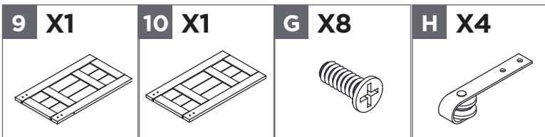
Accrochez quatre poulies de porte (H) sur la barre coulissante (M). Prenez la porte gauche (9) et la porte droite (10) et placez les guides coulissants inférieurs dans la fente du panneau inférieur (11). Fixez les poulies de porte (H) à la porte gauche (9) et à la porte droite (10) au moyen de deux boulons (G) par poulie.
