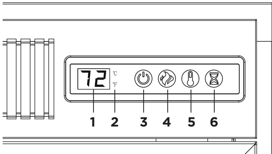
Lorsque les portes coulissantes du manteau couvrent l'unité, le foyer se désactivera automatiquement après 10 secondes et « EO » s'affichera. Pour redémarrer le foyer, glissez la porte à l'écart de l'appareil de chauffage. Assurez-vous que l'alimentation est coupée lorsque l'appareil n'est pas utilisé.
