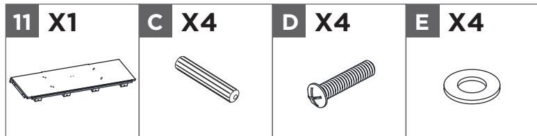
Alignez et fixez l'assemblage de l'étape 2 au bas (11) en utilisant quatre goujons de bois (C), quatre rondelles (E) et quatre boulons (D).
