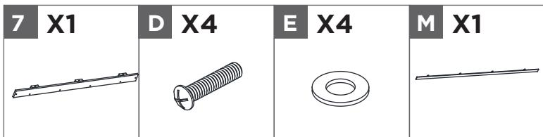
Fixez la barre coulissante (M) à la garniture supérieure (7) au moyen de quatre rondelles (E) et de quatre boulons (D).
