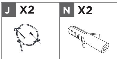
Suivez les instructions imprimées sur le sac en plastique contenant la quincaillerie anti-basculement pour fixer la quincaillerie anti-basculement (J) au meuble et au mur.
