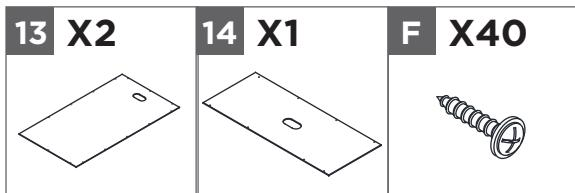
Alignez et fixez les panneaux arrière (13) et le panneau arrière central (14) en place au moyen de quarante vis (F).
