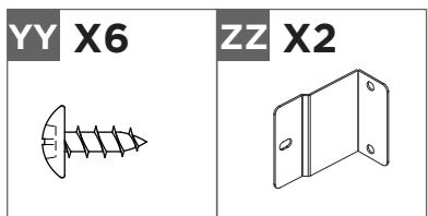
Fixez le foyer au moyen des supports (ZZ), fixez les supports au manteau au moyen de six vis (YY).
