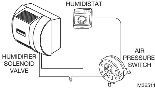
**Fig. 13. Wiring the controls.**
