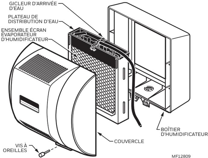
**Fig. 14. Nettoyage de l'humidificateur.**
