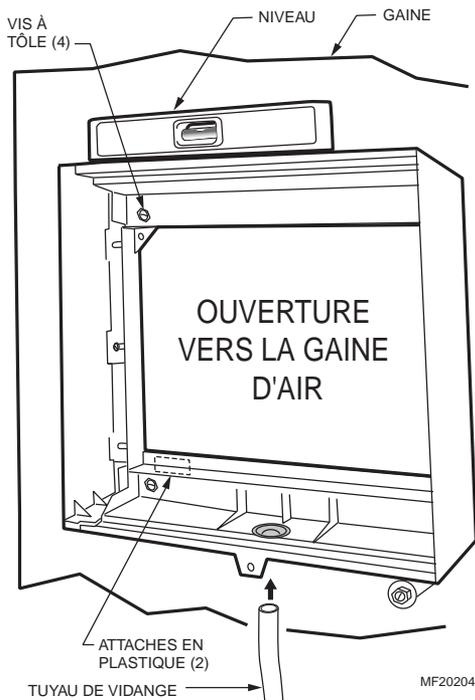
**Fig. 5. Installation de l'humidificateur sur une gainé.**
