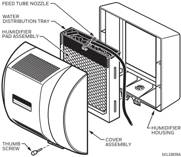
**Fig. 3. Disassembling humidifier.**
