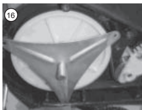
16. Remplacez la plaque de soutien de la poulie et les trois vis de retenue.
