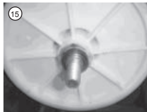
15. Remplacez les deux rondelles d'espacement sur l'arbre de la turbine.
