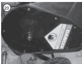
20. Remplacez et serrez les vis restantes, ainsi que l'écrou et la rondelle.
