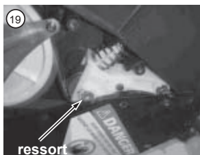
19. Placez le ressort inférieur et remontez le couvercle latéral en appliquant une légère pression pour maintenir le ressort en place.
