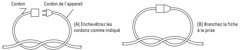
Fig. 3 Méthode de fixation de la rallonge
