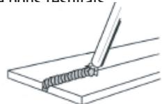
La position plate est la position de soudage la plus simple et la plus commune. Il est préférable de souder en position plate, si vous êtes en mesure de le faire, puisque cette position permet plus aisément d'obtenir de bons résultats.
