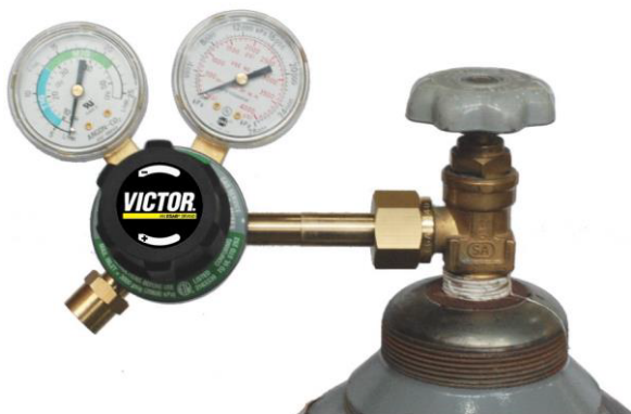
Figura 4-4: Regulador para la válvula del cilindro
