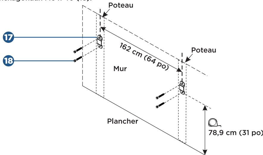
Installez deux autres supports de sécurité (17) des deux côtés de l'armoire avec quatre boulons hexagonaux M6 x 12 (14). Serrez fermement.
