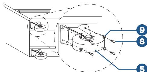
Posez délicatement l'armoire à l'envers sur un tapis doux pour protection. Positionnez deux roulettes fixes (5) sur un côté de la face inférieure de l'armoire. Insérez les boulons hexagonaux M8 x 25 (8) dans les rondelles (9), puis dans les roulettes et le bas de l'armoire. Serrez fermement.
