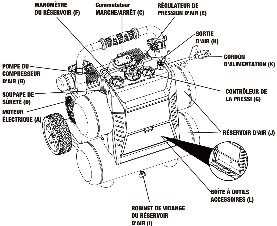
**A. MOTEUR ÉLECTRIQUE :** Le moteur sert à alimenter la pompe. Il est doté d'un dispositif de protection contre la surcharge. En cas de surchauffe du moteur pour quelque raison que ce soit, le dispositif de protection coupe l'alimentation afin d'éviter tout dommage au moteur.
