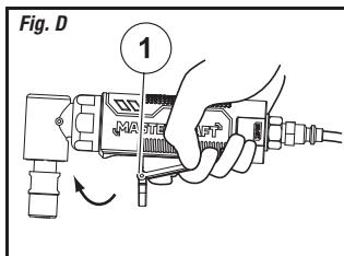
4. En exerçant une prise ferme sur l'outil, appuyez légèrement sur la détente (1) et appliquez l'accessoire sur la pièce, en déplaçant lentement et de manière constante l'outil jusqu'à obtenir la finition souhaitée sur la pièce (Fig. D).
