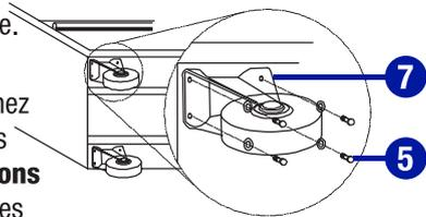
Répétez cette étape pour les deux **roulettes pivotantes (4)** sur l'autre côté de l'armoire. La poignée doit être fixée sur le même côté de l'armoire d'où se trouvent les roulettes pivotantes.
