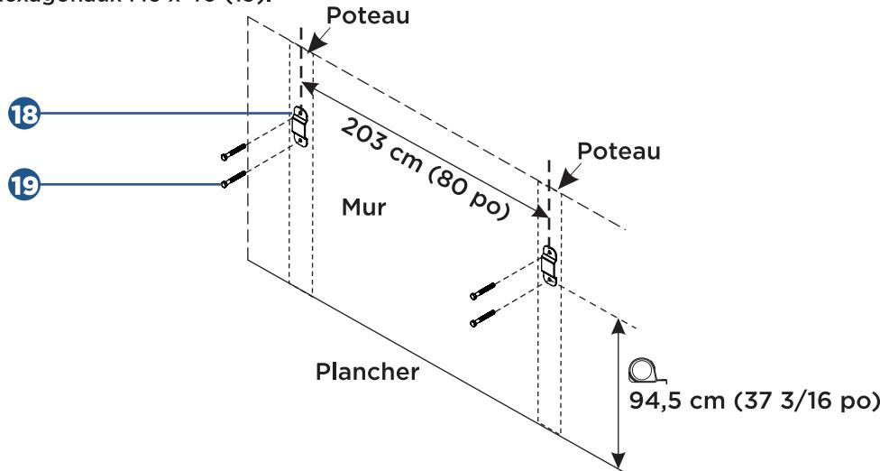
Installez deux autres supports de sécurité (18) des deux côtés de l'armoire avec quatre boulons hexagonaux M6 x 12 (2). Serrez fermement.
