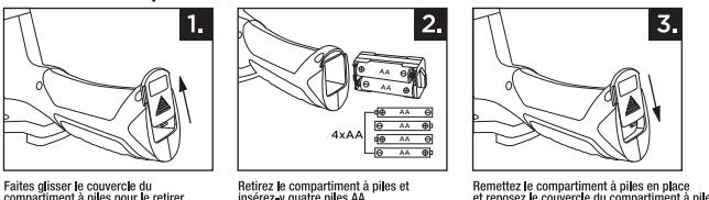
Faites glisser le couvercle du compartiment à piles pour le retirer.
