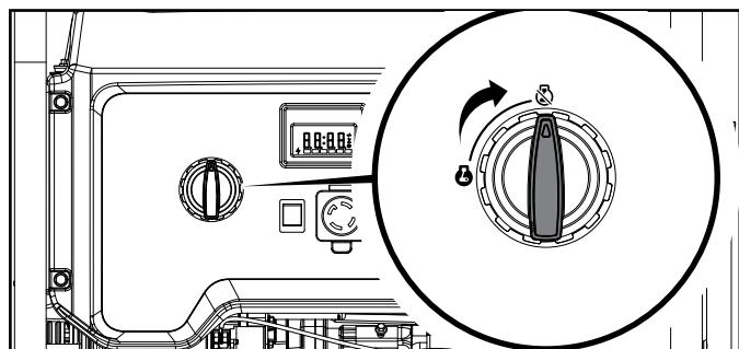
**Important :** Assurez-vous toujours que le cadran de carburant en position « FERMÉ/ARRÊT » lorsque la génératrice n'est pas utilisée.
