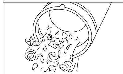
4 Videz tous les débris ou saletés accumulés dans le réservoir et le tuyau dans un contenant à déchets approprié.
