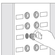
**REMARQUE :** Mettre l'interrupteur mural qui commande le luminaire en position d'arrêt n'est pas suffisant pour éviter les chocs électriques.
