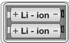
Vos piles sont installées dans le compartiment des piles à l'arrière du boîtier de la lampe. Placez le commutateur à la position OFF/ARRET avant d'ouvrir le compartiment des piles. Retirez les quatre vis pour accéder aux piles.
