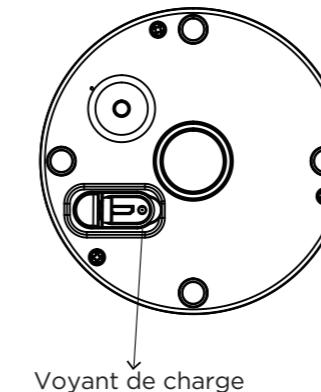
Si la pile ne peut pas être chargée ou si elle est complètement chargée mais ne fonctionne pas comme avant, remplacez la pile. Retirez les vis et remplacez la pile par une pile rechargeable du même type (3,7 V 18650, 2 000 mAh). Consultez l'illustration ci-dessous.
