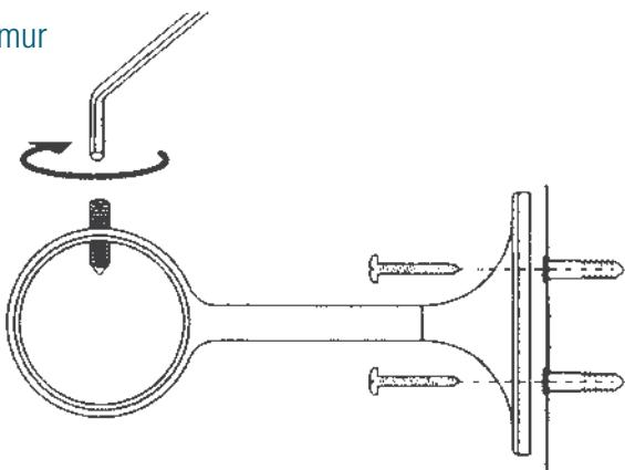
**NOTE:** Convient aux tringles mesurant jusqu'à 1" (2,5 cm) de diamètre.
