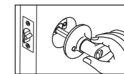
Installez le bec-de-cane intérieur et serrez les vis jusqu'à ce que la serrure soit fermement en place.
