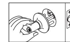
Insérez la tige dans le mécanisme du verrou. Pressez fermement le cylindre contre la porte de sorte qu'il n'y ait aucun espace entre celui-ci et la porte.
