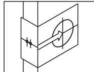
La distance d'entrée correspond à la distance entre le bord de la porte et le centre du trou de la serrure sur la surface de la porte. Certains modèles viennent avec un verrou ajustable qui convient à des distances d'entrée de 60 ou 70 mm (2 3/8 po ou 2 3/4 po). Il suffit de suivre les étapes décrites ci-dessous pour changer de distance d'entrée.
