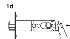
Pour remettre le verrou à 60 mm (2 3/8 po), poussez la came à l'extrême gauche du trou d'ajustement.
