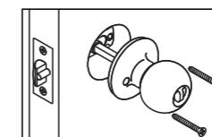
Installez la rosette et le bouton intérieur sur l'axe. Puis serrez les vis jusqu'à ce que la serrure soit fermement en place.
