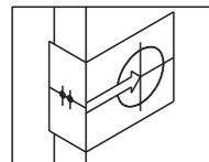
La distance d'entrée correspond à la distance entre le bord de la porte et le centre du trou de la serrure sur la surface de la porte. Certains modèles comprennent un verrou ajustable qui convient à des distances d'entrée de 60 mm (2 3/8 po) ou 70 mm (2 3/4 po). Il suffit de suivre les étapes décrites ci-dessous pour changer de distance d'entrée.
