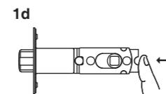
Pour remettre le verrou à 60 mm (2 3/8 po), poussez la came à l'extrême gauche du trou d'ajustement.
