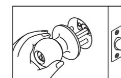
Insérez l'axe du bouton dans le verrou de la serrure. Assurez-vous que la rosette est de niveau avec la porte. Remarque : le trou de la serrure doit être orienté vers le bas.
