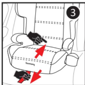
4. En tirant sur la sangle de réglage avant, resserrer le dispositif «SAU» tout en poussant le siège d'appoint vers le dossier du siège du véhicule (3).
