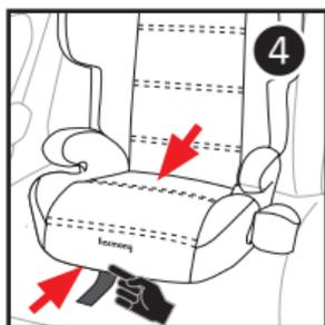
5. Pour desserrer le dispositif «SAU», pousser le bouton de déverrouillage du dispositif «SAU» vers le haut et tirer le siège d'appoint vers l'avant (4).
