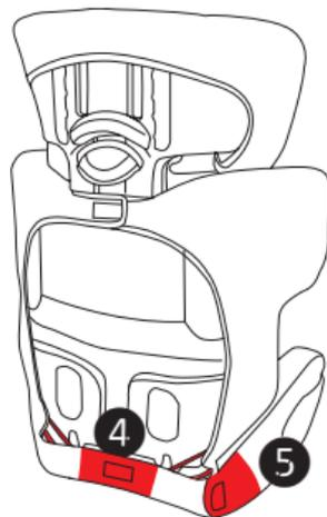
2. Tout en maintenant la housse vers le bas à l'arrière de la base du siège, balancer doucement le dossier vers le haut, ce qui verrouillera le dossier en place **3**. Les boucles et attaches de la housse à l'arrière du siège devraient être **EN-DESSOUS** de le dossier **4**.
