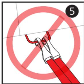
**! AVERTISSEMENT: NE JAMAIS** rattacher deux connecteurs du dispositif «SAU» à un seul ancrage du véhicule désigné «SAU» (5).
