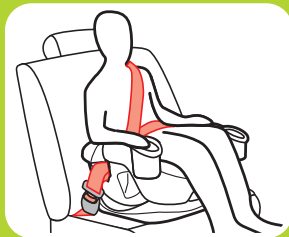
Ceinture de sécurité sous-abdominale/diagonale du véhicule
