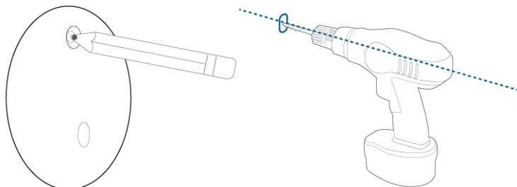
2. Maintenez la plaque de montage sur le mur et assurez-vous que la flèche "UP" pointe vers le haut, puis fixez la plaque de montage sur le mur ou le plafond avec les vis.
