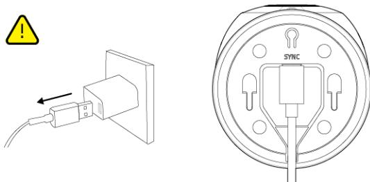
4. Pour le montage mural, placez le câble dans le canal de câble de la plaque de montage.
