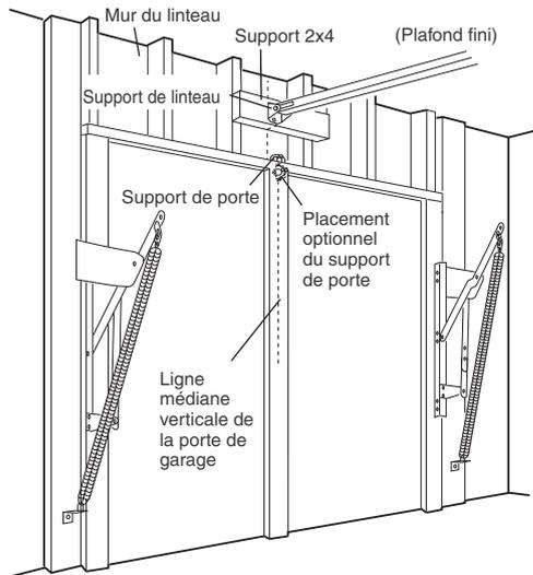
Pour une porte sans bâti apparent ou pour l'installation optionnelle, utilisez des tirefonds 5/16 po x 1-1/2 po (non fournis) pour fixer le support de porte.
