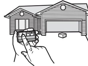
L'ouvre-porte de garage ne se fermera pas à partir d'une télécommande si le témoin lumineux de l'un ou l'autre des capteurs est éteint (ce qui vous avertit du fait que le capteur est mal aligné ou obstrué).
