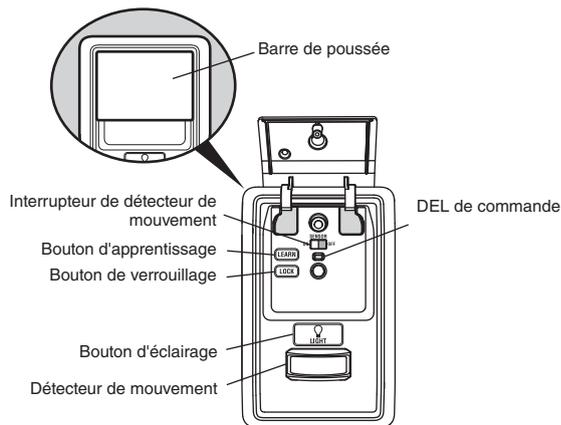
**SYNCHRONIZER LA COMMANDE DE PORTE :** Pour synchroniser la commande de la porte à l'ouvre-porte du garage, appuyez sur la barre de poussée jusqu'à ce que l'ouvre-porte du garage se mette en fonction (cela peut prendre jusqu'à trois poussées). Essayez la commande de la porte en appuyant sur la barre de poussée, chaque poussée sur la barre de poussée activera l'ouvre-porte du garage.
