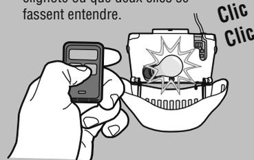
**6** Pour tester, appuyer sur le bouton programmé de la télécommande..
