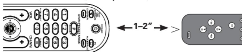
2. Sur la télécommande « apprentrie », appuyez et gardez enfoncée la touche d'appareil sous laquelle vous désirez utiliser la fonction apprise (la touche POWER s'allume et demeure allumée). En maintenant enfoncée la touche de l'appareil, utilisez votre autre main pour appuyer et maintenir enfoncée la touche RECORD (la touche POWER s'éteint).
