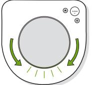
Lorsque le robot détecte que son bac a besoin d'être vidé, le voyant DEL s'allume en rouge avec un mouvement de balayage vers l'arrière.
