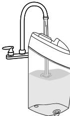
Remplissez d'abord le réservoir d'eau propre avec de l'eau tiède du robinet, puis videz-le complètement pour le rincer. Ensuite, remplissez-le de nouveau avec de l'eau chaude du robinet et replacez le réservoir dans l'appareil.
