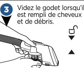
Éteignez l'appareil. Tenez le godet et tournez-le dans le sens inverse des aiguilles d'une montre afin d'aligner la flèche et le symbole de déverrouillage; retirez le godet.
