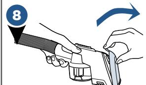
Pour enlever tout poil ou débris piégé de la buse, éteignez d'abord l'appareil. Tirez la languette de la buse hors de l'accessoire pour l'enlever et la rincer à l'eau courante.
