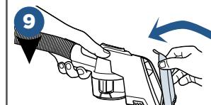
Replacez l'accessoire en alignant le bord de la buse et enclenchez-le en place. Avant de ranger l'appareil, assurez-vous que tous les poils sont retirés du godet sec et que la buse a été rincée à l'eau courante.
