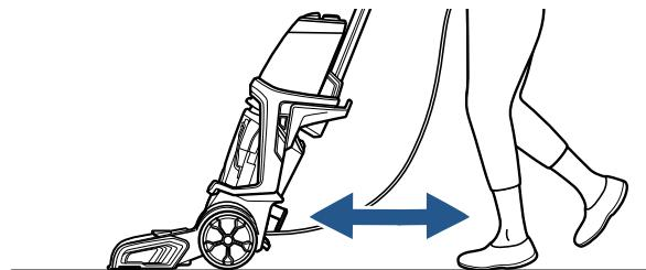
**Pour vidanger et rincer l'appareil :** Mettez l'appareil en marche et appuyez sur la gâchette pendant 15 secondes tout en faisant des mouvements de va-et-vient sur une partie de la moquette.
