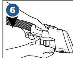
Pour fixer de nouveau le godet, alignez-le sur les encoches de l'accessoire et tournez-le dans le sens des aiguilles d'une montre. La flèche s'alignera avec l'icône de verrouillage une fois le godet fixé.
