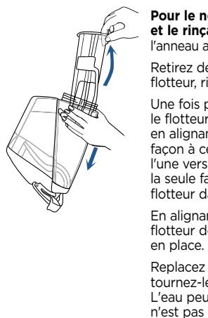
**Pour le nettoyage final et le rinçage :** Dévissez l'anneau au fond du réservoir.
