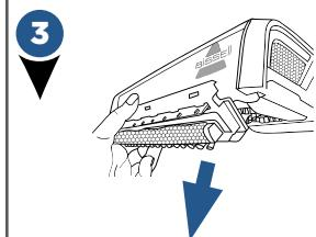
Lorsque vous avez terminé, débranchez l'appareil et retirez l'accessoire pour planchers nus en le tournant vers le haut pour le décocher de la buse.
