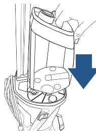
Dans le bas du manche supérieur, alignez le réservoir aux rainures et glissez le réservoir en place.
