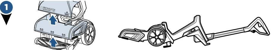
Alors que l'appareil est en position verticale, débranchez-le et retirez les deux réservoirs. Retirez la buse et le couvercle du rouleau de brosse (consultez les étapes de la section Entretien du rouleau de brosse et de la buse). Appuyez sur la pédale d'inclinaison et placez l'appareil sur le dos.
