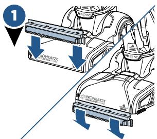
Alors que l'appareil est débranché, fixez l'accessoire pour planchers nus au bas de l'appareil en alignant l'accessoire au rebord de la buse. Tournez-le vers le bas jusqu'à ce qu'il se loge en place; vous entendrez un déclic.
