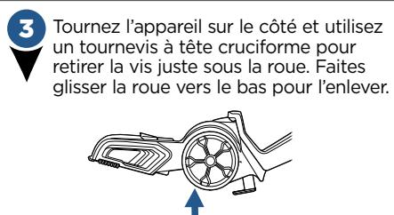
3 Tournez l'appareil sur le côté et utilisez un tournevis à tête cruciforme pour retirer la vis juste sous la roue. Faites glisser la roue vers le bas pour l'enlever.
