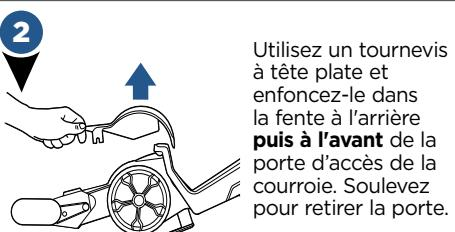
Utilisez un tournevis à tête plate et enfoncez-le dans la fente à l'arrière **puis à l'avant** de la porte d'accès de la courroie. Soulevez pour retirer la porte.
