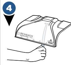
À ce stade, la buse et le couvercle du rouleau de brosse peuvent être rincés à l'eau courante et l'accessoire de nettoyage de la buse peut être inséré pour débloquer les poils ou les débris.
