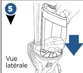
Dans le bas du manche supérieur, alignez le réservoir d'eau propre aux rainures et glissez le réservoir en place.
