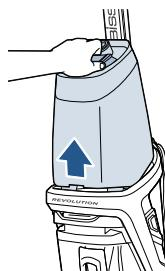
Levez le réservoir directement vers le haut pour le retirer de l'appareil.
