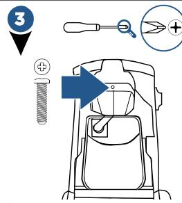
À l'aide d'un tournevis à tête cruciforme, fixez la poignée de transport avec la vis collée au manche supérieur.
