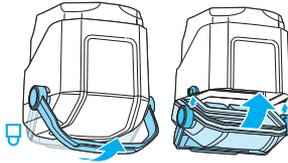
**6.** Remplacez le réservoir d'eau sale sur la machine.
