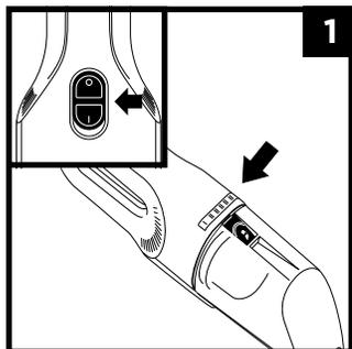
1. Faites glisser l'interrupteur en position « O » pour l'éteindre. Appuyez sur le bouton de déverrouillage du compartiment à poussière et retirez le compartiment à poussière.
