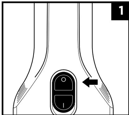
1. Assurez-vous de mettre l'appareil en position « O » pour l'éteindre avant de le recharger.
