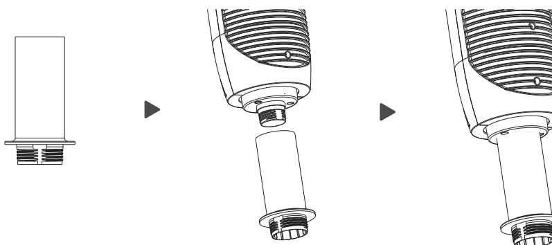
3. Fixez le corps du ventilateur au socle au moyen de l'écrou en plastique.
