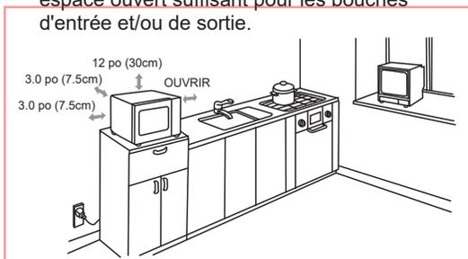
Un espace minimum de 3.0 pouces (7,5 cm) est requis entre le four et les murs adjacents. Un côté doit être ouvert.
