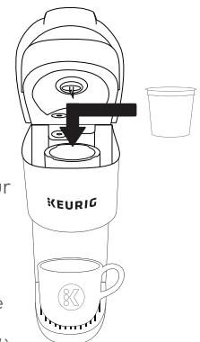
**Infusion à haute altitude :** En tenant la poignée de la cafetière en position levée, poussez doucement la capsule K-Cup® dans le support à capsule jusqu'à ce que le dessous de la capsule K-Cup® soit perforé par l'aiguille de sortie.
