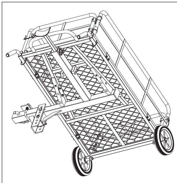
2. Faites rouler la plate-forme porteuse avec les roues près du support (B) depuis le côté trottoir. Assurez-vous que les deux guides en forme de coin sous la plate-forme (A) se trouvent entre les deux pointes du support (B). Maintenez la plate-forme (A) en position inclinée et faites-la glisser vers le haut jusqu'à ce que l'extrémité des guides en forme de coin repose sur la poutre carrée du support (B), vérifiez et assurez-vous que les deux loquets A sont verrouillés dans les deux pointes.
