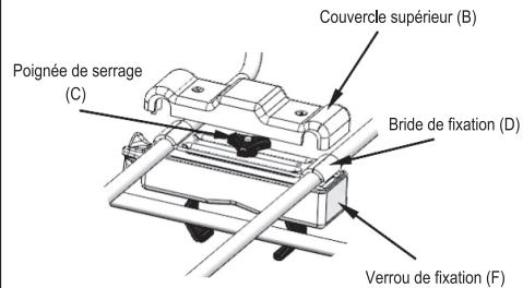
Placez le verrou de fixation (F) sous les barres transversales, fixez la bride de fixation (D) sur les barres transversales et glissez le verrou de fixation de manière à ce que le boulon à collet carré du verrou de fixation passe à travers la bride de fixation et puisse être serré au moyen de la poignée de serrage (C). Vérifiez si l'ensemble est approprié et si toutes les pièces sont attachées.
