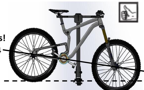
**Le vélo doit être aussi à niveau que possible pour éviter toute éjection. Un adaptateur de vélo CCM040-1574 peut être nécessaire pour la sécurité**
