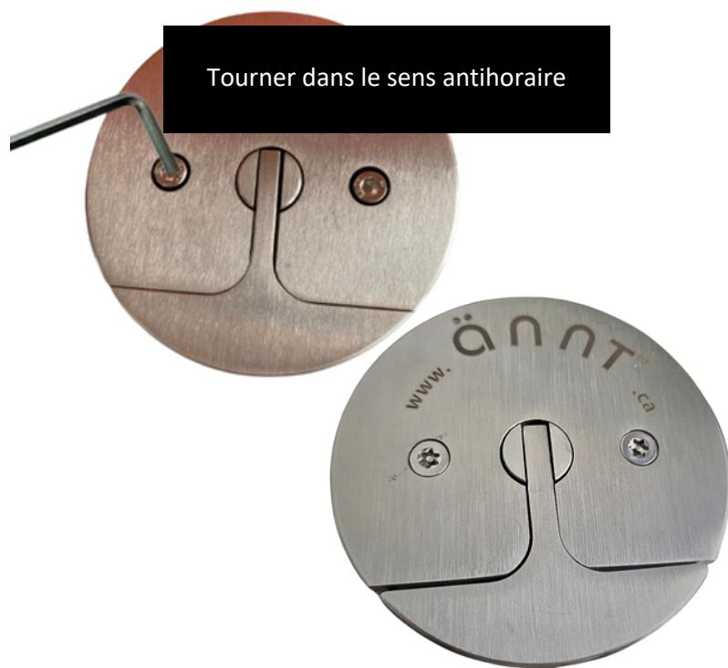
3. En fonction du modèle de votre borne, utilisez soit une clé hexagonale, soit votre outil personnalisé pour desserrer les boulons (ou les vis anti-effraction) situés sur le dessus de la borne. Retirez les boulons ainsi que le capot en acier inoxydable.
