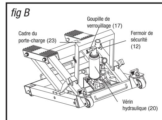
B Afin d'installer la barre de verrouillage (11), alignez-la dans les articulations à cliquet (2) des deux côtés et fixez-la solidement à l'aide de rondelles (10) et d'écrous (9) .
