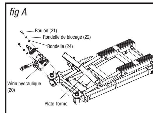
2 Fixez le vérin hydraulique et la barre de verrouillage
